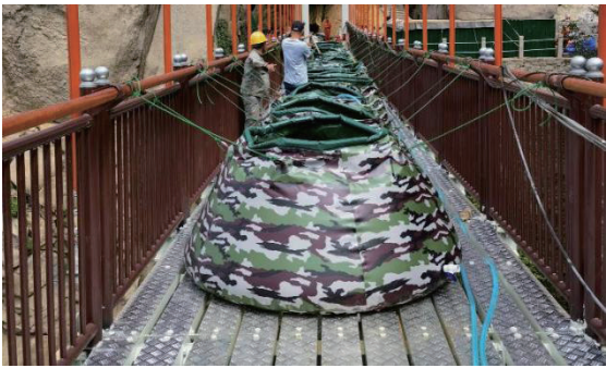
图 3 现场水袋加载图
