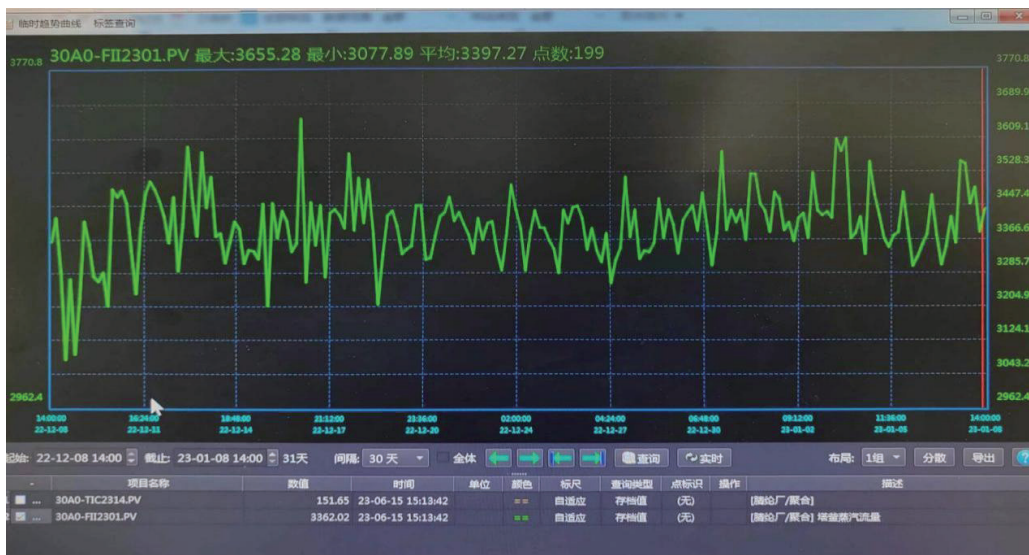
图 5 PID 参数调节前蒸汽趋势图
