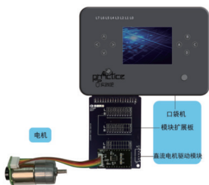
图2 口袋机模型控制直流驱动电机连接电路
